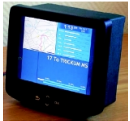
Joonis 4. Sõidukitesse paigaldatav pardaarvuti C90Plus. Arvutisse sisestatakse linna kaart, millel kuvatakse bussiliini kulgmine ja liikumine reaajas. Allikas: Thoreb AB
